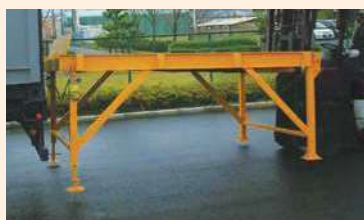
架台1をコンテナに接続
